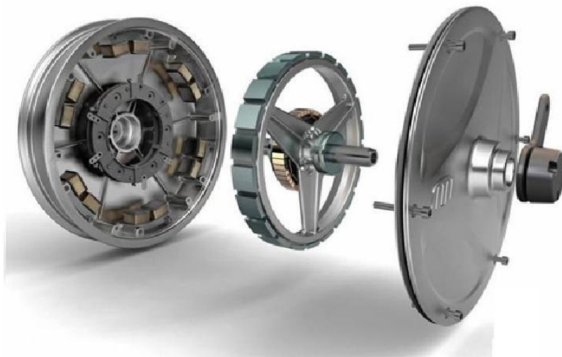
Диаграмма 9. Мотор-колесо В.В. Шкондина
